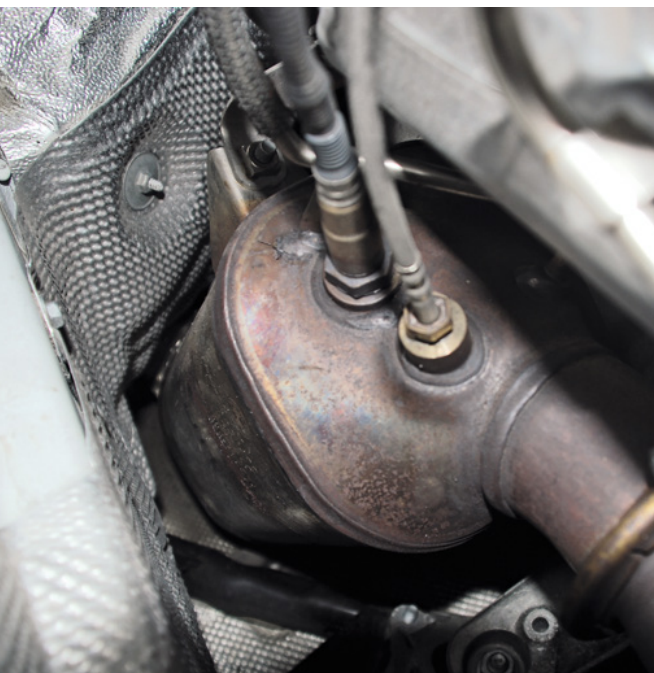
Dieselpartikelfilter: Mit der Zeit sammelt sich Ruß und Asche an. Bild: Schmidt
