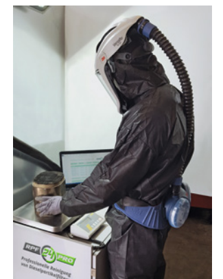
Gewichtsmessung vor und nach der Reinigung. Gut erkennbar ist das geöffnete Filtergehäuse ohne Beschädigung des Kerns. Bild: RPF24Pro
