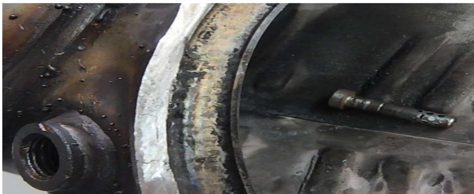
z.B.: Teile von aufgebohrten Temperatursensoren, die unweigerlich in den DPF Filter fallen, können bei geschlossenen DPF nicht mehr entfernt werden.
